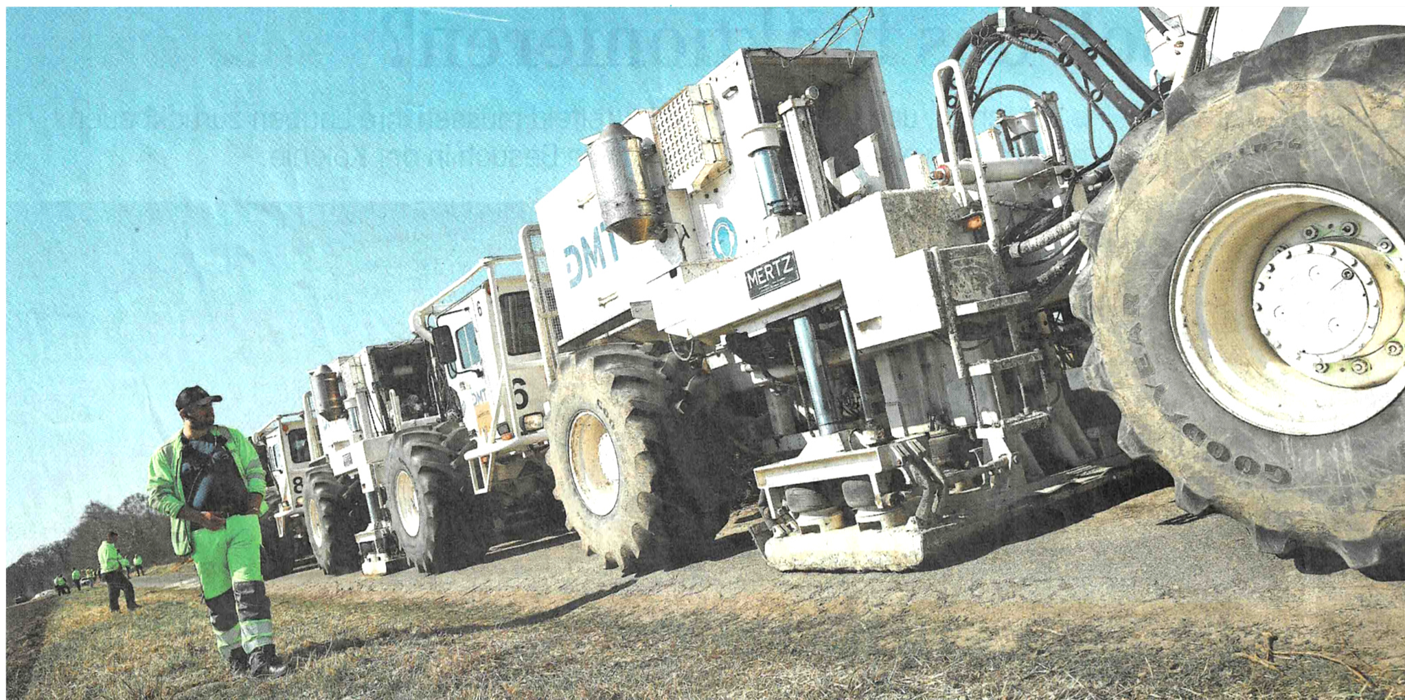
Im Konvoi unterwegs: Jeweils drei „Vibrotrucks“ senden bei Stopps Schallwellen in den Boden, um das Gestein zu vermessen. Begleitfahrzeuge sichern die Fahrzeuge.
