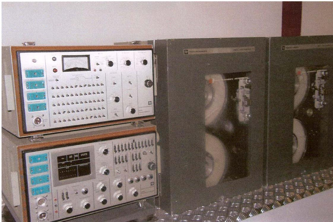
Die **Magnetogramme** konnten noch während des Messbetriebs beim Trupp über die Aufnahme- Apparatur als normale Seismogramme wiedergegeben werden, z.B. zur Beurteilung des Messergebnisses.
