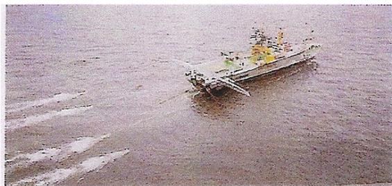
Ein modernes seismisches Hochseemeßschiff auf Meßfahrt. Die Schallwellen werden erzeugt durch den Ausstoß hochkomprimierter Luft. Deutlich sichtbar die gerade feuernden vier Luftpulserbatterien.
