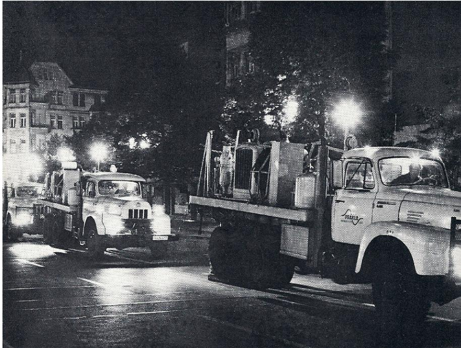
Einsatz von Vibratoren bei seismischen Messungen in Berlin
