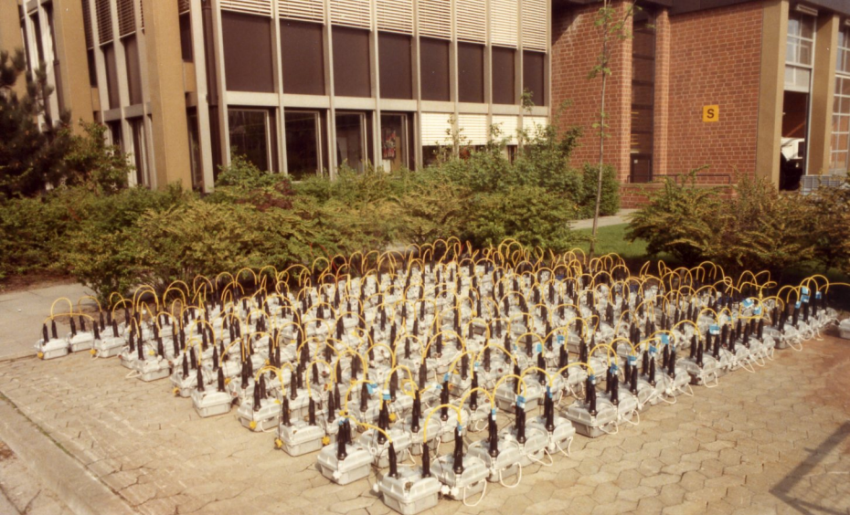
Telemetrie Testaufbau-Typ Sercel 368
