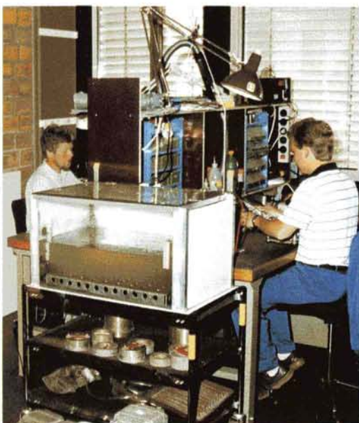
Lötplatz - Das Becken dient zur Überprüfung der Wasserdichtigkeit der Boxen
