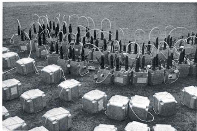
Endprüfung der 'Station-units' vor dem Versand zum Meßtrupp
