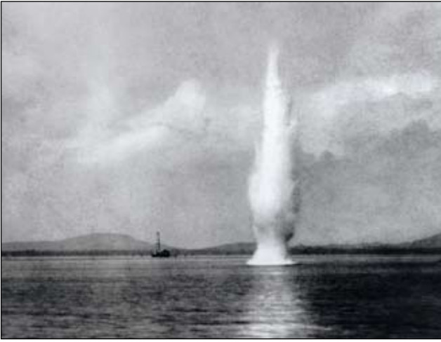
“Flachwasser-Seismik“ in der Lagune Tamiahua/Mexiko im Juli 1923.
